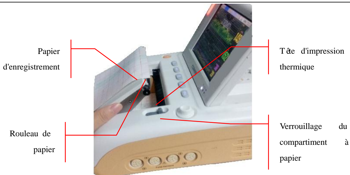
Fig 11-1 Chargement du papier d'enregistrement
