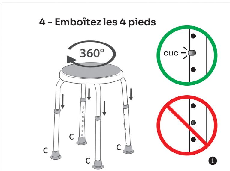
**IMPORTANT :** Veillez à bien serrer les vis et à contrôler régulièrement le bon maintien de celles-ci. Veillez vous rapprocher de votre revendeur en cas de vis défectueuses, de jeux dans l'assise suite au montage et/ou si les cliquets permettant le réglage de la hauteur ne ressortent pas correctement (voir illustration ❶).
